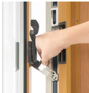
開き幅を40mmに制限します。ガラス清掃などの場合は、ピンにかかったストッパーをはずせば解除できます。また、障子を閉めることで自動的にストッパーがセットされます。
